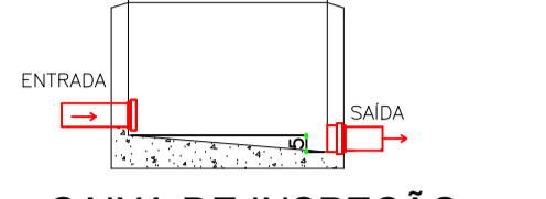
CAIXA DE INSPEÇÃO CORTE - ESC. 1:25
