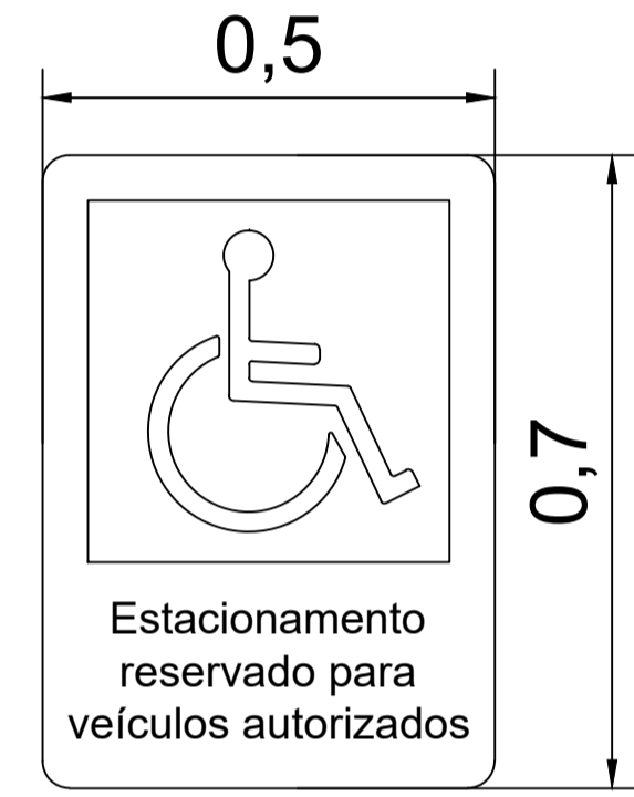
Estacionamento reservado para veículos autorizados
